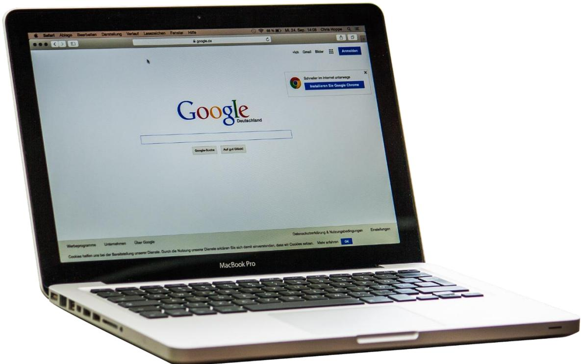
Le PC portable intègre tous les composants : écran, clavier, pavé tactile (touchpad) ou/et capuchon tactile (trackpoint) permettant de déplacer le pointeur souris... il est équipé de nombreuses connexions carte SD, carte d'identité; USB et autres permettant la connexion de divers périphériques.
